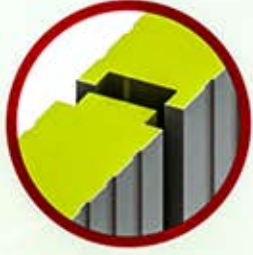
Panel Birleşim Detayı
