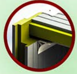
Duvar - Tavan Birleşim Detayı
